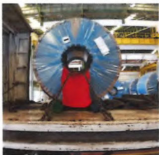
รีดโซ่เกรด 43 (พิกัดรับแรงรัดตึง 5 ตัน) จำนวน 2 เส้นต่อเหล็กม้วน
